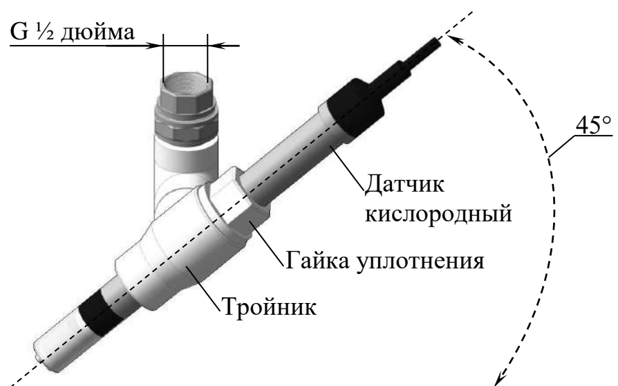
Рисунок 2.11 – Держатель датчика с установленным датчиком кислородным
